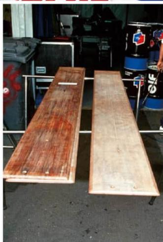
サンマリノGPの事故によりFIAは、通常行なわれる周知・開発・検証プロセスを経ることなく車両規定を変更。インダクションポッドは切り取られたり穴が開けられ(写真上)、スキッドブロックを床面に張り付けることが決められた(写真下)。
